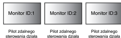
Rysunek 1 Pilot działający w trybie standardowym lub opcja REMOTE ID jest ustawiona na wartość 0
