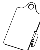
Cubierta del interruptor principal
