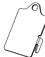
Крышка главного выключателя питания
