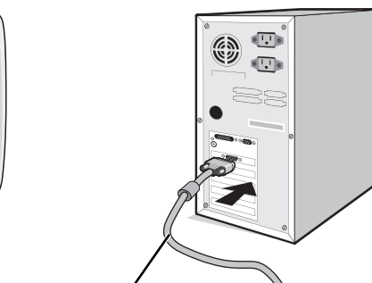
Кабель видеосигнала с 15-контактным разъемом mini D-SUB
